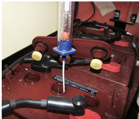
Afbeelding 6-8. Het soortelijk gewicht van de elektrolyt meten
